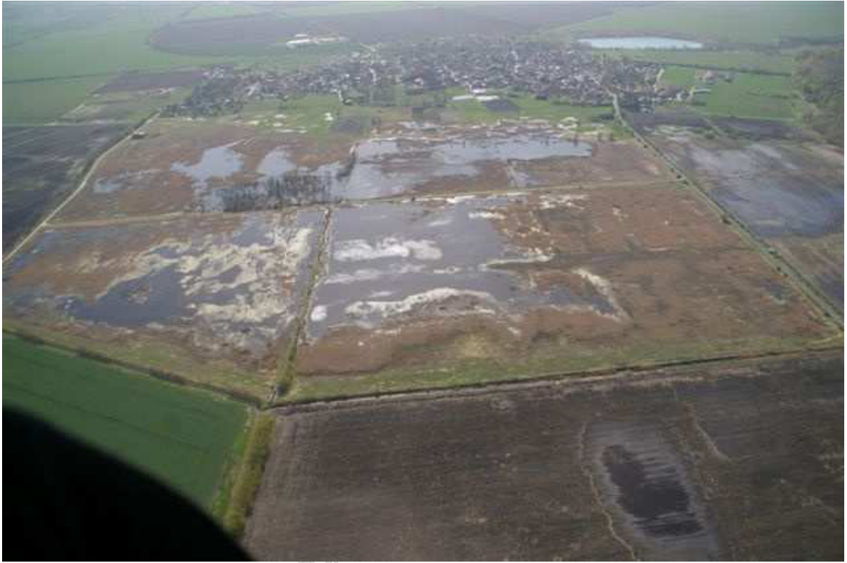
Vernässungsflächen einer Agrar GmbH im Umfeld des Tgb. Nachterstedt vor der Installation einer Pumpengalerie (nach dem Kollaps des Nachterstedter Böschungssystems) Ort: Tgb. Nachterstedt/RL Frose/Sachsen-Anhalt Quelle: Copyright: M. Lersow; Tag der Aufnahme: 30.12.2009
