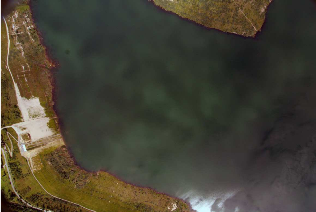
Nachterstedter Böschungssystem mit Slipanlage ; Aussichtspunkt mit Grubenbahn und Infrastruktur als Anschluss an die Siedlung „Am Ring“; im Tagebaurestsee hat sich ein gewaltiger Umwelttracer (Eintrübungsfahne), bestehend aus ausgetragenem Kippenböschungsmaterial, ausgebreitet Quelle: Copyright: M. Lersow; Tag der Aufnahme: 14.06.2009
